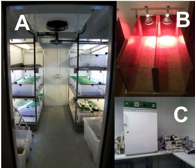
Figura 22. Câmaras térmicas (A), gradiente experimental (B) e respirómetro (C).
